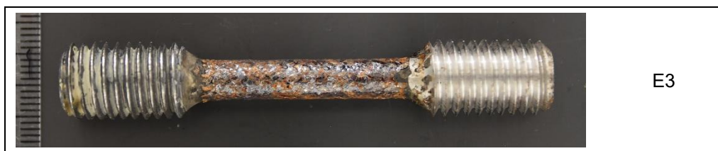
Figura 1. Probetas de acero X52N sin envejecimiento y tras los diferentes envejecimientos
